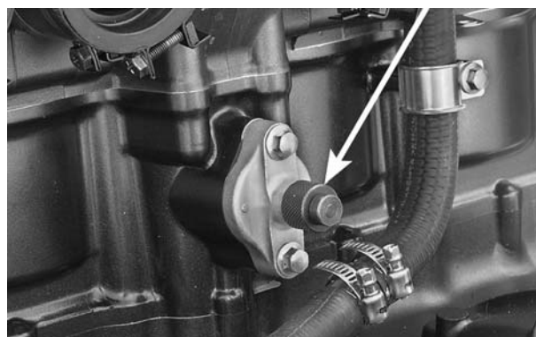
ACIONADOR DO TENSOR DA CORENTE DE DISTRIBUIÇÃO
